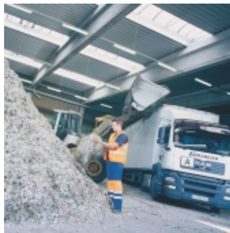
Im Produktlager einer mechanischen Aufbereitungsanlage der Tönsmeier-Gruppe wird ein Walking-Floor-Fahrzeug mit EBS beladen.
