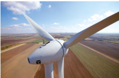
Für Rotorblätter von Windkraftanlagen verwendet man Epoxidharze, deren Zusatzstoff Epichlorhydrin bei Solvay in Rheinberg hergestellt wird.
