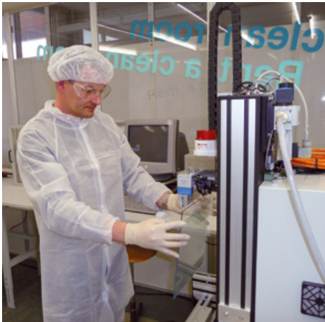
In einem Reinraum des Bad Hönninger Solvay-Werks wird eine Glasplatte mit einer speziellen Beschichtung versehen, die das Durchleiten von Strom und Licht ermöglicht.
