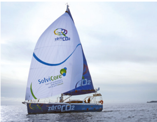
Das Forschungsschiff Zéro CO 2 ist die erste Segelyacht, deren Manövriermotor mit einer Brennstoffzelle betrieben wird.
